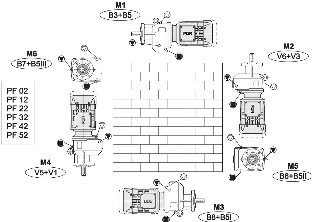
⊙ Havalandırma tapası / Vent plug    ● Boşaltma tapası / Drain plug    ▼ Yağ Seviye tapası / Oil level
