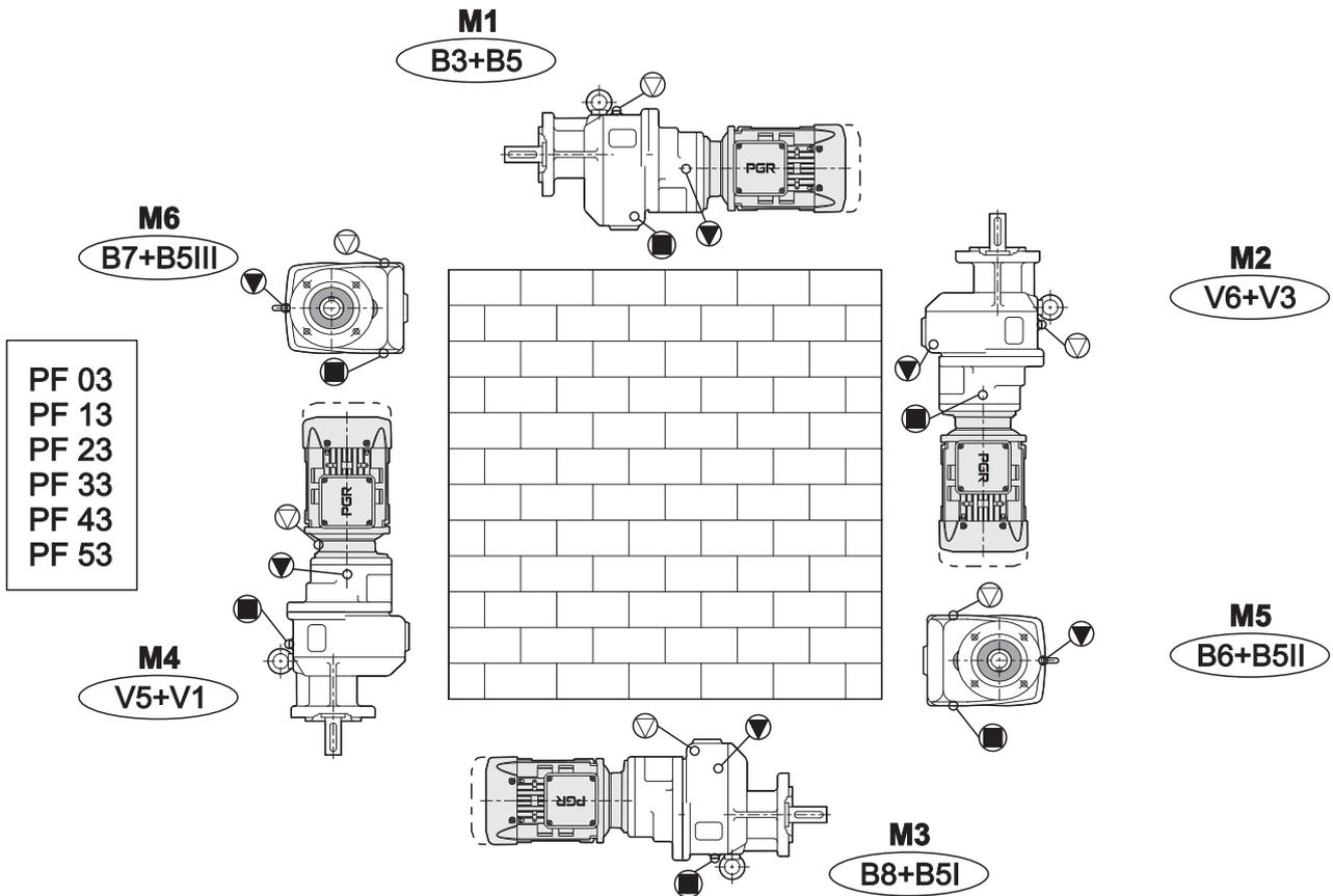
⊙ Havalandırma tapası / Vent plug    ● Boşaltma tapası / Drain plug    ▼ Yağ Seviye tapası / Oil level
