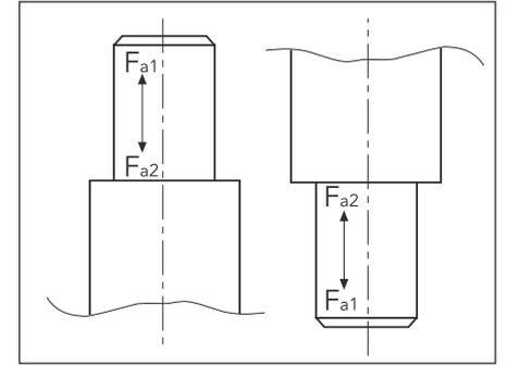
Hesaplamalar 20.000 saat (L10aah) rulman ömrü baz alınarak yapılmıştır. Radyal ve axial yüklerin aynı anda etkimesi durumunda değerler değişecektir. Kritik uygulamalarda kapakların mekanik mukavemeti de dikkate alınmalıdır.
