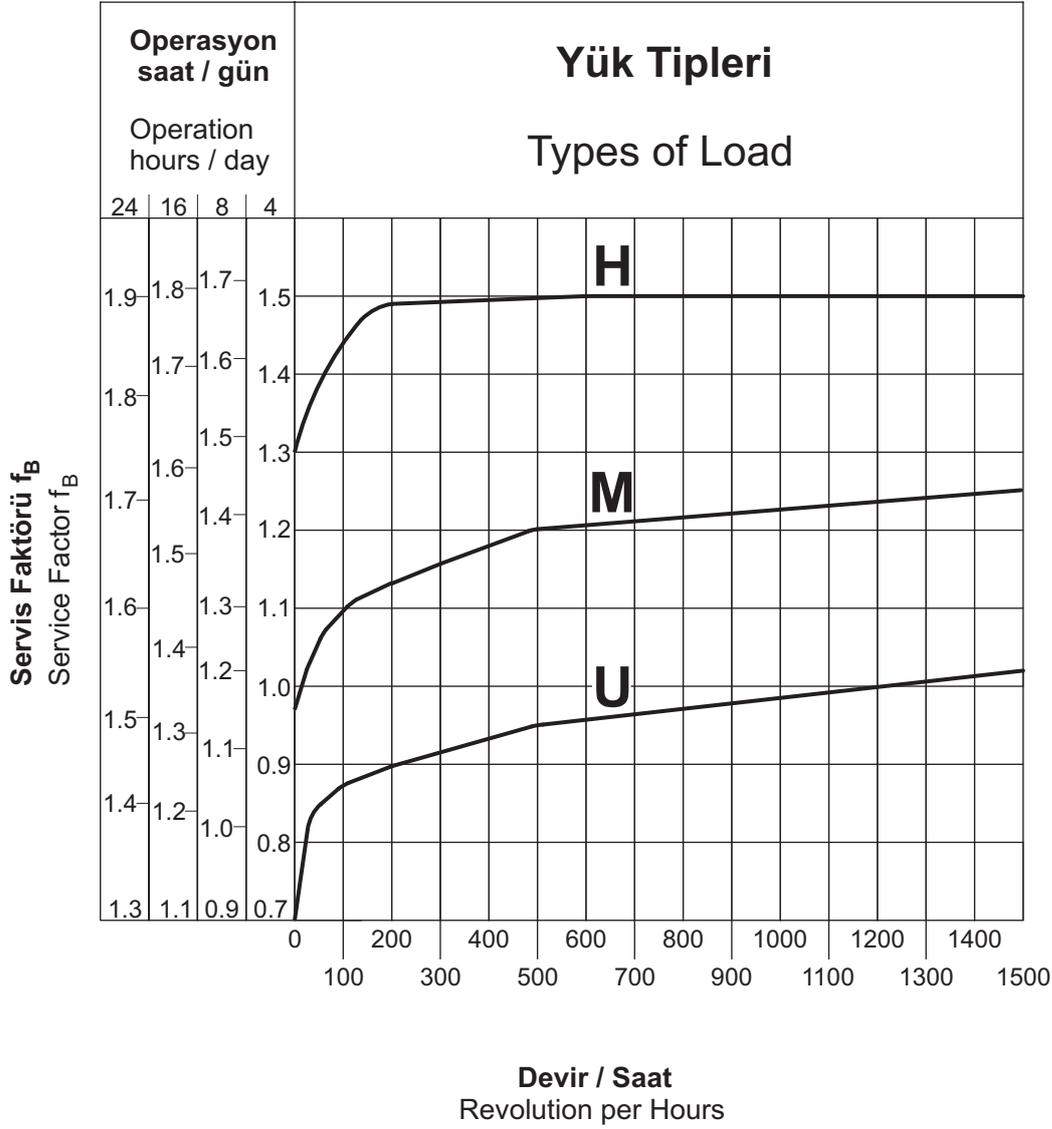
Diyagram 1, günlük çalışma zamanına bağlı gerekli minimum servis faktörü  $f_{B\min}$ , 'Z' saatteki çevrimleri, ve uygulama yükü sınıflandırması 'U', 'M', 'H' gösterir. Çalışma düzgünlüğüne ve kütle hız faktörüne bağlı olarak, üç yük sınıflandırması belirlenmiştir. Hareket ettiren makineden gelen etkiler çalışma düzgünlüğü sınıflandırmasında tanımlanırken, kütle hız faktörü en fazla olan yük üzerinde etkili olur.
